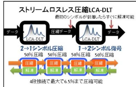
図 新圧縮技術の特徴。データが圧縮器に入力されると次々に圧縮されたデータが出力され、復号化側に伝搬し、復号化側では圧縮データを1つでも受け取ると、圧縮側で作られた変換テーブルが復元され、復号されていきます。さらに、1段で50%圧縮（2→1シンボル圧縮）可能なモジュールを多段接続することで、ハードウェア量と圧縮率を選択できます。
