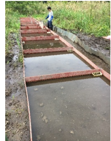
窒素浄化試験区
