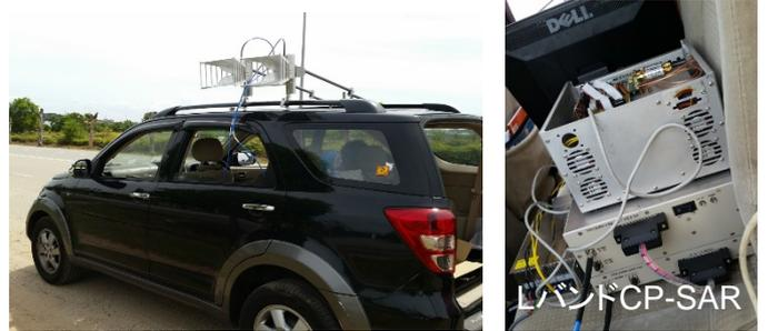
図1. 高速道路周辺監視用の車載用CP-SARシステム
