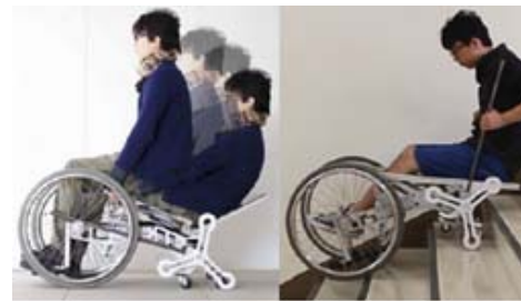
(2)モータなしで段差踏破できる車椅子
