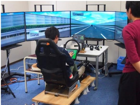
ドライビングシミュレータを用いて、自動運転システムをシミュレータに実装し、認知科学的見地からHMIをデザインし、実験心理学的手法によって厳密な実験計画を立案し、実験データを統計学的に分析します。
