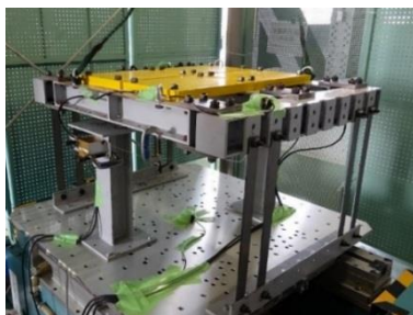
図 1 小型振動台を用いた耐震実験
